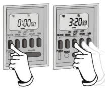
2). Programación de tiempos de encendido y apagado: Pulse el botón "TIMER" para ingresar al menú de programación; en este visualizará paso a paso las 8 programaciones de encendido y apagado que se pueden memorizar. En principio visualizará la primera programación de encendido (1 ON) para lo cual deberá pulsar los botones "DAY", "HOUR" y "MIN" y así ajustará el día ó los días en que usted quiera que el contacto de salida cambie de estado.
