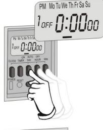
Cuando haya terminado de memorizar las programaciones de encendido y apagado, pulse el botón "CLOCK" para volver a la pantalla principal. Si desea modificar la hora de cualquiera de las programaciones, bastará con pulsar el botón "TIMER" y ubicar la programación que requiere cambiar, después de ubicada pulsará los botones "DAY", "HOUR" y "MIN" hasta ajustar el horario deseado, seguidamente pulsará el botón "CLOCK" para volver a la pantalla principal.
