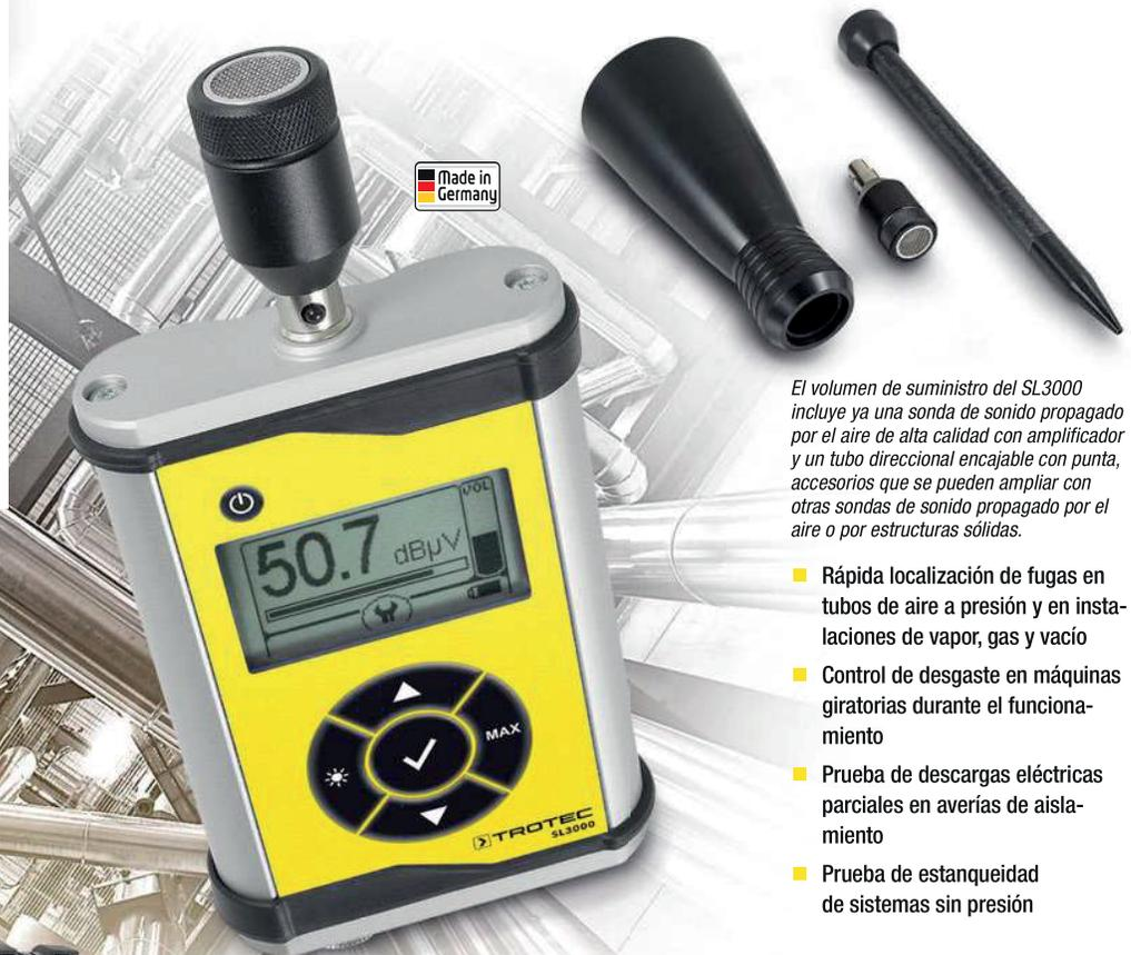
*El volumen de suministro del SL3000 incluye ya una sonda de sonido propagado por el aire de alta calidad con amplificador y un tubo direccional encajable con punta, accesorios que se pueden ampliar con otras sondas de sonido propagado por el aire o por estructuras sólidas.*
