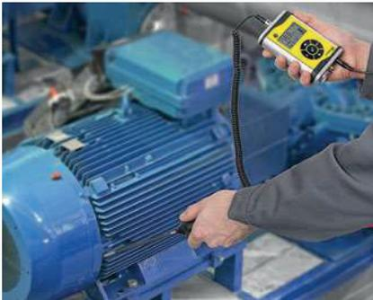
La sonda de sonido propagado por estructuras sólidas con punta de acero inoxidable resulta ideal para pruebas no destructivas como los controles de desgaste de rodamientos en piezas de máquina giratorias.
