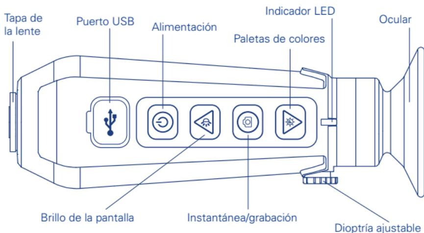
**Carga de la Scout TKx:** Use el cable USB que se incluye y conéctelo a una fuente de alimentación. El indicador LED destella durante la carga y parpadea en verde cuando se ha completado la carga.
