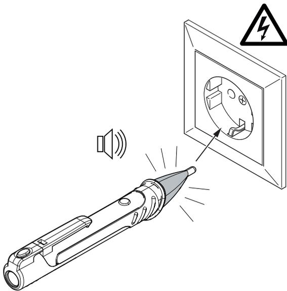
1. Compruebe **antes de cada medición** que el comprobador de tensión funciona. Para ello ponga la punta de medición (4) en una fuente de tensión conocida.
