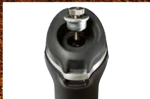
El Instituto de equipos de seguridad (SEI) ha certificado que la FLIR K65 cumple con la norma 1801-2013 de la NFPA®. Los conectores de la cámara (parte superior) están completamente sellados y la batería (parte inferior) se puede fijar dentro de la cámara con un tornillo.
