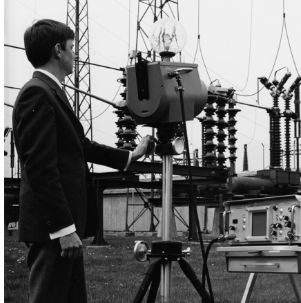
Figura 13.2 1969: Thermovision modelo 661 de 1969. La cámara pesaba unos 25 kg, el osciloscopio 20 kg y el trípode 15 kg. El usuario también necesitaba un generador de 220 V CA y un recipiente de 10 litros con nitrógeno líquido. A la izquierda del osciloscopio se puede observar el accesorio Polaroid (6 kg).
