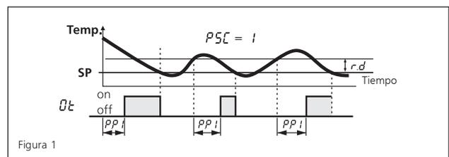
El segundo control prevé la inhibición de la salida "OT" por un intervalo mínimo configurado en el parámetro "P.P2", después que la salida fue apagada (retraso después de apagar o tiempo mínimo de compresor encendido).
