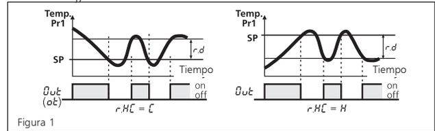
En caso de error de medida de la sonda, es posible que la salida configurada como "OT" continúe funcionando cíclicamente de acuerdo con el tiempo configurado parámetro "R.T1" (tiempo de salida encendida) y "R.T2" (tiempo de salida apagada).
