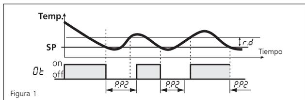
El tercer control determina el tiempo mínimo entre accionar la salida "OT", configurado en el parámetro "P.P3" (retraso entre partidas).
