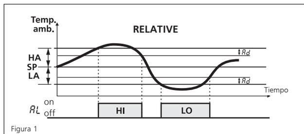
Las alarmas de temperatura pueden ser inhabilitadas configurando los parámetros "A.HR" y "A.LR" = OF.
