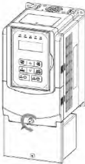
Paso 1: Destornille la tapa
