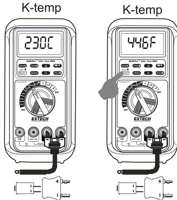
Nota: Asegure insertar el conector banana del termopar tipo K con la **+** – polaridad correcta.
