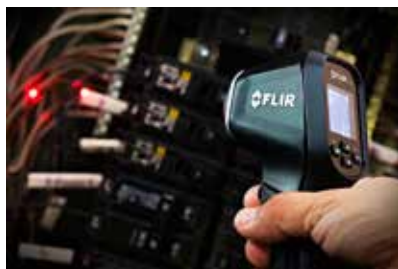
Identifique fácilmente la ubicación de las mediciones gracias al láser incorporado
