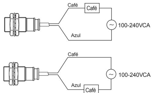
※La carga se puede conectar a cualquiera de los cables.
