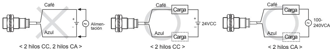
Cuando use sensores de proximidad de 2 hilos CC y CA, deberá conectar una carga, de otra manera los componentes internos se pueden dañar. La carga se puede conectar a cualquier conductor.
