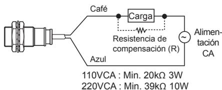
Puede haber una falla en el retorno de la carga debido a un voltaje residual. Si la corriente de carga está por abajo de 5mA, asegúrese de que el voltaje residual sea menor que el voltaje de retorno de la carga conectando una resistencia de compensación en paralelo con la carga como se ve en el diagrama.
