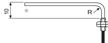
Precaución 1) Al flexionar la parte SUS, no lo flexione menos de 10 mm.
