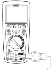
**Nota:** La sonda para temperatura está equipada con un mini conector tipo K. Se suministra un adaptador de mini conector a conector banana para conectar a los enchufes de entrada.
