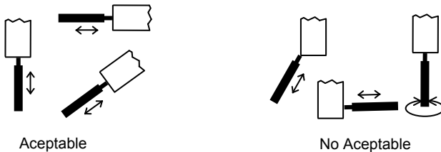
Figura 1 – Ángulos correcto e incorrecto para medición
