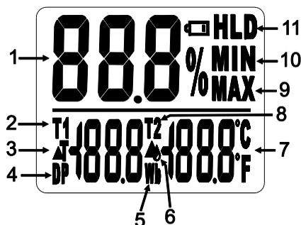
*\*T1 representa la temperatura del aire medida por el sensor interno. T2 representa la temperatura indicada medida por el sensor de temperatura (externo) opcional (TP890). Las temperaturas de punto de rocío y bulbo húmedo son cálculos basados en temperatura del aire T1 y humedad relativa. Las indicaciones de temperatura T1 menos T2 y T2 menos Punto de rocío sólo están disponibles cuando se conecta un sensor de temperatura opcional TP890.*
