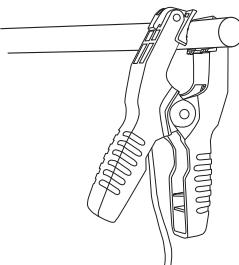
**Nota:** Para tener mejores resultados, la superficie deberá estar limpia de impurezas o sustancias que inhiban el contacto térmico..
