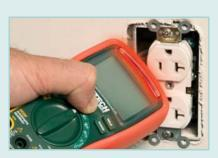
Detector de voltaje sin contacto integrado automáticamente detecta un alambre vivo cuando el LED rojo se ilumina con zumbador audible
