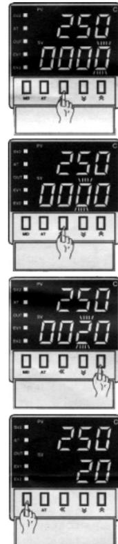
1. En caso de cambio del valor programado en el estado de ARRANQUE, oprima la tecla "<<". El dígito 10° del indicador SV titilará.
